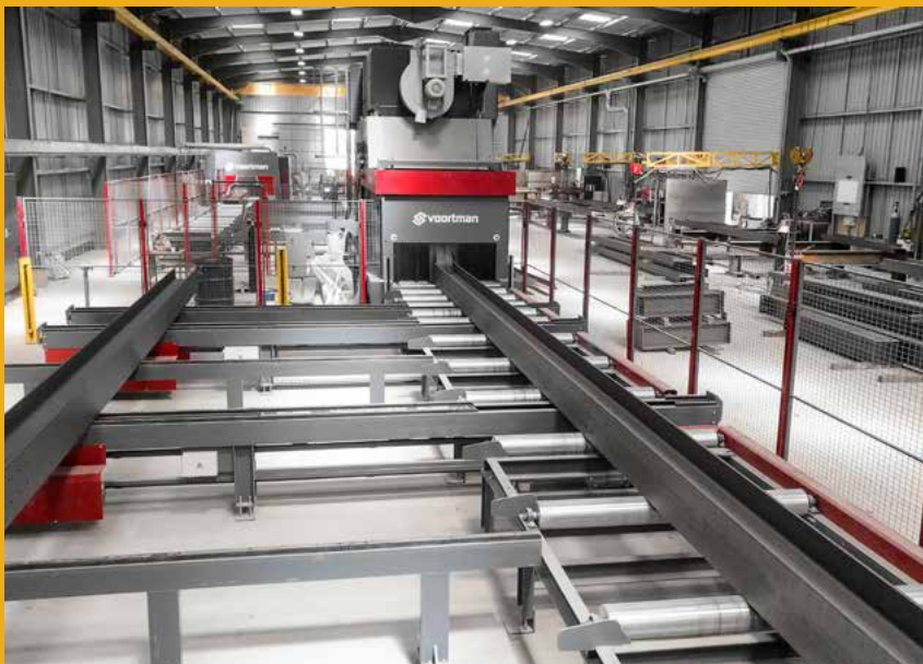
Installation of split MSI line with Voortman V807 robotic coping machine – Voortman (UK) Ltd
